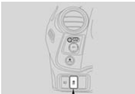
BUTONUL DE DEZACTIVARE A SISTEMULUI VSA
