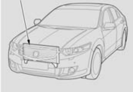
CONDENSATORUL INSTALAȚIEI DE AER CONDIȚIONAT
